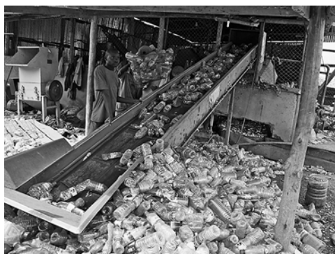
写真3 リサイクル工場にて ここからペットボトルが機械に投入されていく。時間差で異なる色のペットボトルを粉碎する。（2013年7月11日撮影）
